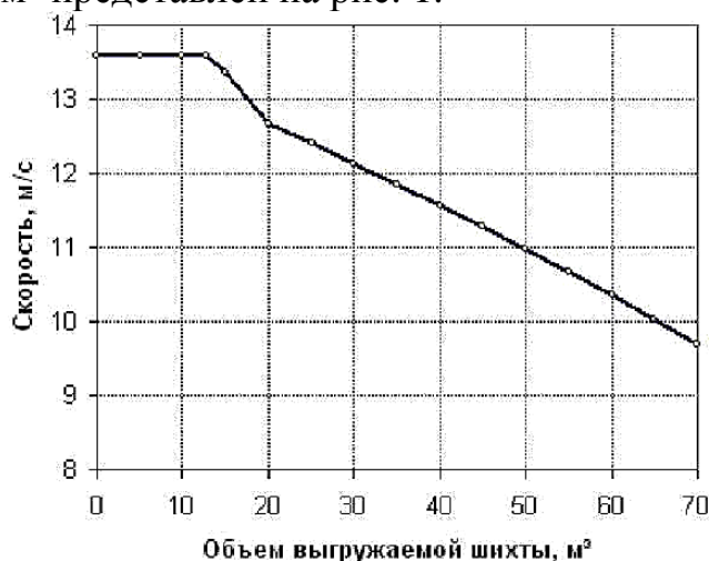
Рисунок 1 - Скорость падения шихтовых материалов в бункер БЗУ в зависимости от объема загруженной шихты
